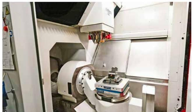
内部视图：重量补偿的Z轴具有长度补偿的主轴和可对齐的冷却液喷头。旋转转台配备了零点夹紧系统 (照片：Klaus Vollrath)
